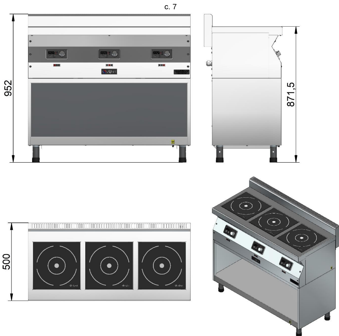
Рис. 5. Плиты КИП-35Н-3,5, КИП-35Н-5,0 с подставкой (модулем нижним) МН-35
